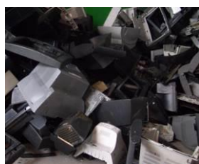
Figure 6 : Coques plastiques de télévisions avant broyage (Crédit Deloitte)
