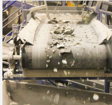
Figure 10 : Panneau photovoltaïque broyé (© Soren) 18
