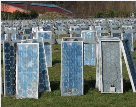
Figure 9 : Panneaux PV en fin de vie (© Soren)
