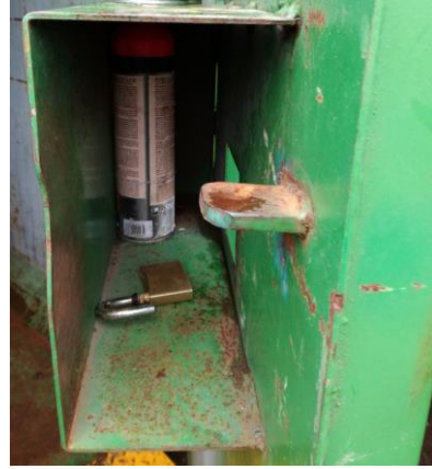
Système de cadenas à l'intérieur du caisson pour empêcher le coupage
