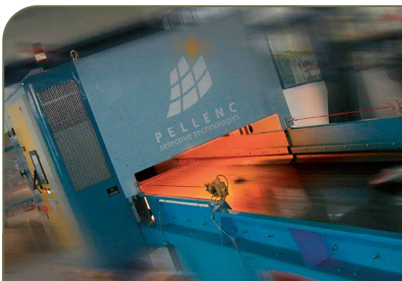
Machine de tri BOREAS pour la séparation des différentes qualités de papiers.
