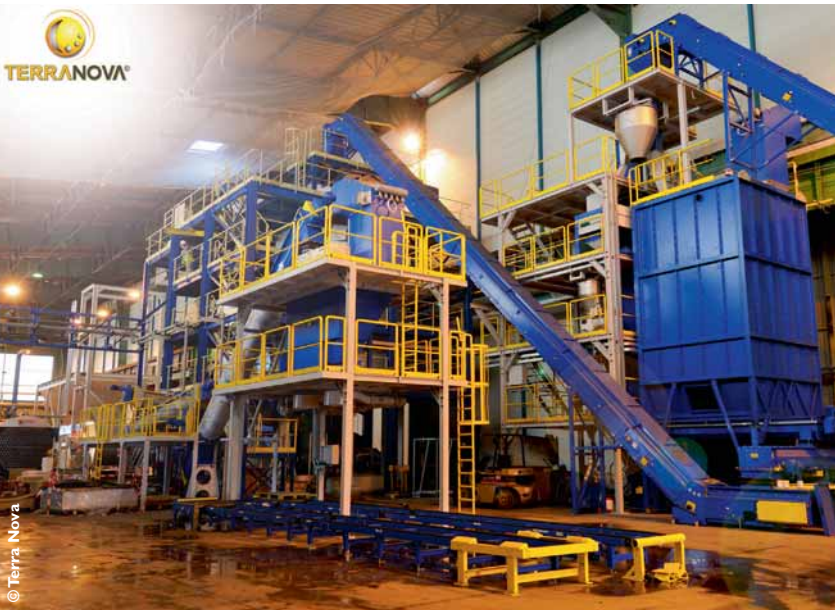
Unité de valorisation des cartes électroniques Terra Nova.
