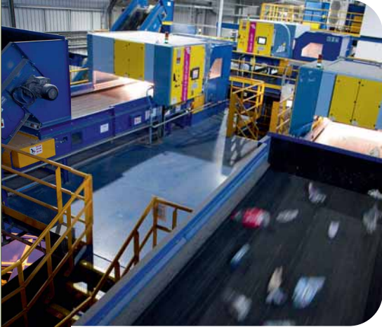
Machine de tri des plastiques – Pellenc ST.
