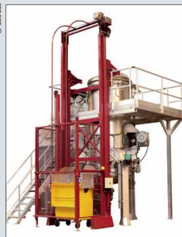
Ecodas T2000 pour le traitement par stérilisation des DASRI.
