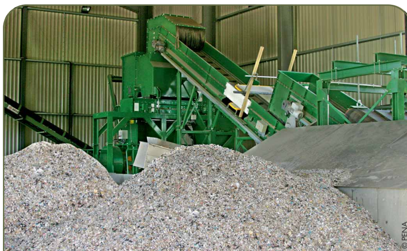
Chaîne de production de CSR granulateurs – Société PENA.
